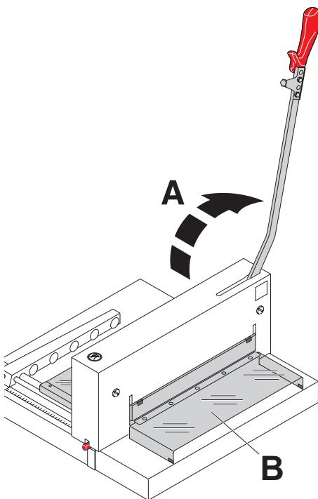
**D** Den Messerhebel (**A**) nach jedem Schneidvorgang ganz **nach oben stellen**. Der Schneidvorgang kann nur ausgeführt werden, wenn die Haube vorne (**B**) nach unten geklappt ist.
