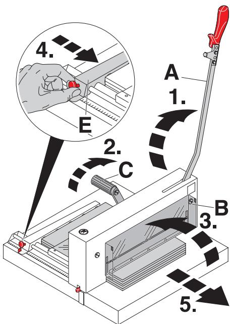
**D** Nach dem Schneiden des Papierstapels, Messerhebel (**A**) in obere Ausgangsposition zurückführen, Handgriff für Pressung (**C**) nach rechts schwenken, Haube vorne (**B**) nach oben klappen und den Papierstapel mit dem Rückanschlag (**E**) nach vorne schieben und der Maschine entnehmen.
