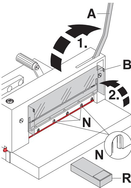
**D Messerwechsel von der Maschinen-Vorderseite aus vornehmen:**
