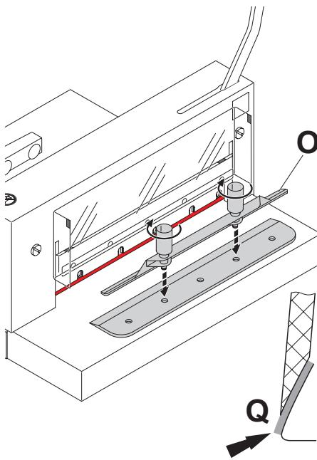
**D** Austauschmesser vorsichtig aus Messerkasten nehmen und mit Messerwechselseinheit fest verschrauben! (**O**).
