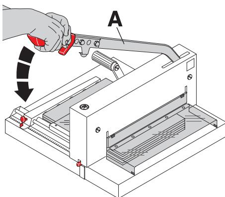
**D** Messerhebel (**A**) mit beiden Händen nach unten ziehen.
