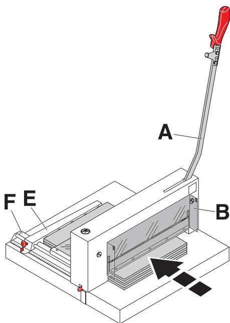
**D** Der Messerhebel (**A**) steht in der oberen Ausgangsposition, Haube vorne (**B**) nach oben klappen, Papierstapel von vorne in die Maschine einschieben und hinten am Rückenschlag (**E**) und links am Seitenanschlag (**F**) exakt anlegen.
