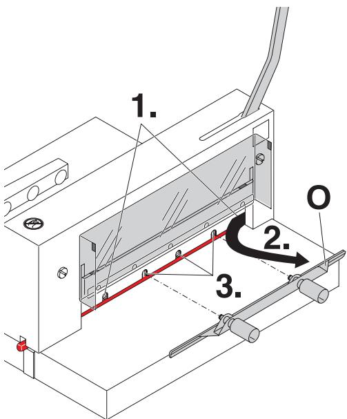
**D** Die beiden äußeren Messerschrauben zuerst leicht festschrauben (1.), Messerwechselvorrichtung (O) entfernen (2.).
