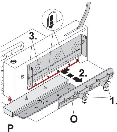
**D** Die Griffe der Messerwechselvorrichtung (**A**) vorsichtig etwas lösen (1.). Das Messer mit Messerwechselvorrichtung (**O**) nach unten entnehmen (2.). Messer in den dafür vorgesehenen Messerkasten (**P**) legen und festschrauben (3).
