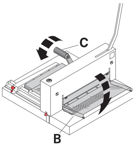
**D** Handgriff für Papierpressung (**C**) vor jedem Schnitt nach links umlegen und mit einem leichten Ruck arretieren.
